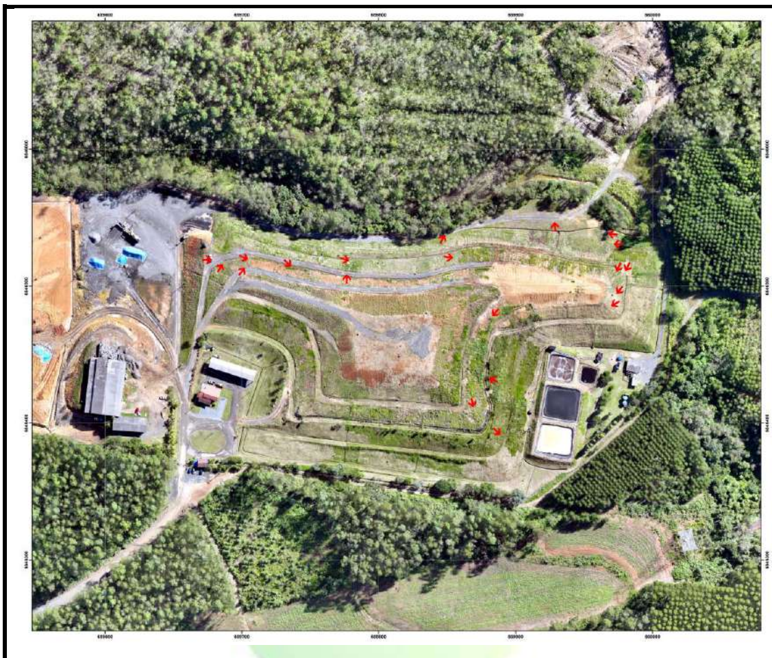
Figura 7: Direção do deslocamento do talude.
